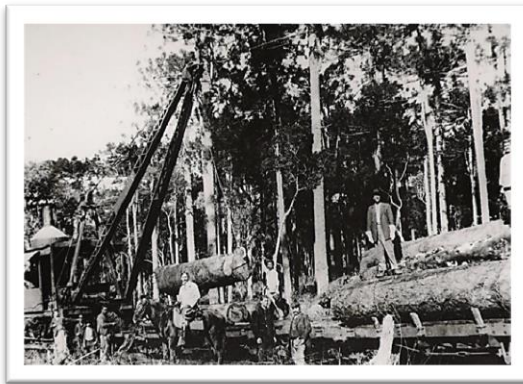
Figura 21 - O carregamento das toras contava com a ajuda de um poderoso guincho e longos cabos de aço. Foto de Claro Jansson.
